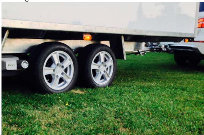
Distancia al suelo con lanza regulable en longitud y altura
