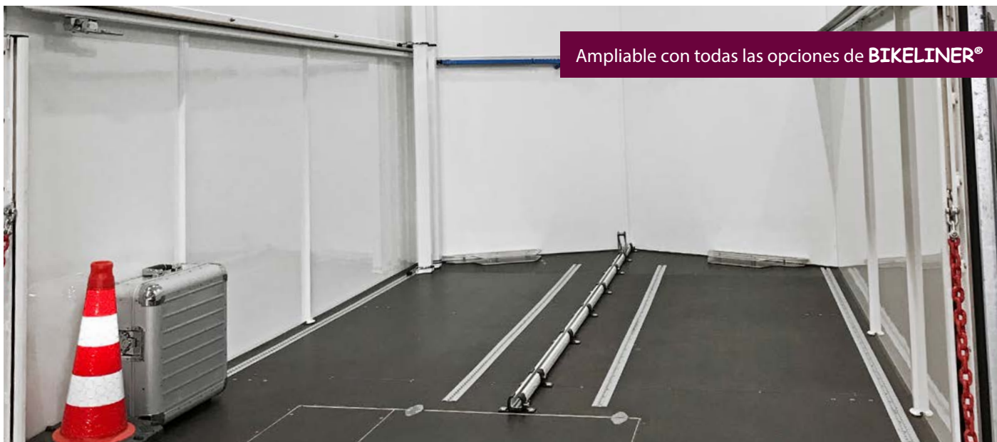
BIKELINER® Luggage Line para equipaje de hasta 2,5 t, incl. sistema de seguro de carga y protección antirobo conformes a la norma BAG
