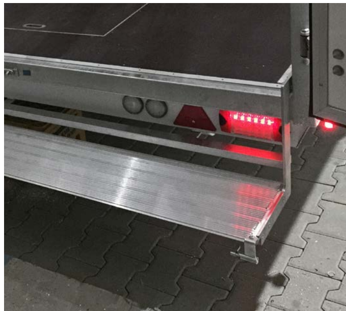
Escalera plegable o extensible para la variante de puerta trasera
